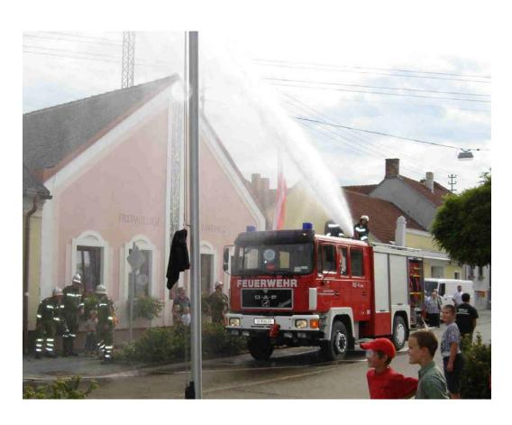
Im Gegensatz dazu der Einsatz unseres Wasserwerfers, der am Dach des Rüstlöschfahrzeuges montiert ist. Mit diesem Wasserwerfer sind Wurfweiten bis zu 40m möglich. Der Wasserverbrauch beträgt 1600 Liter. Um dieses Gerät in Einsatz zu bringen, muss auch die dementsprechende Wasserversorgung sichergestellt sein. Dies geschieht durch unser Hydrantennetz, durch Gewässer oder eine Zisterne.
