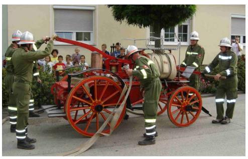
In diesem Löschwagen befindet sich ein Wasserbehälter mit einem Inhalt von maximal 100 Liter.
