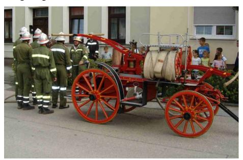
Die FF Gr. Schweinbarth besitzt einen Löschwagen aus dem Jahr 1924. Mit diesem Gerät, das anno dazumal von Pferden gezogen wurde, konnte man mit genug Feuerwehrkameraden einen Löschangriff vornehmen. Dies geschah mittels einer manuell zu betätigenden Pumpe, die von zumindest 4 Kameraden bedient werden musste.
