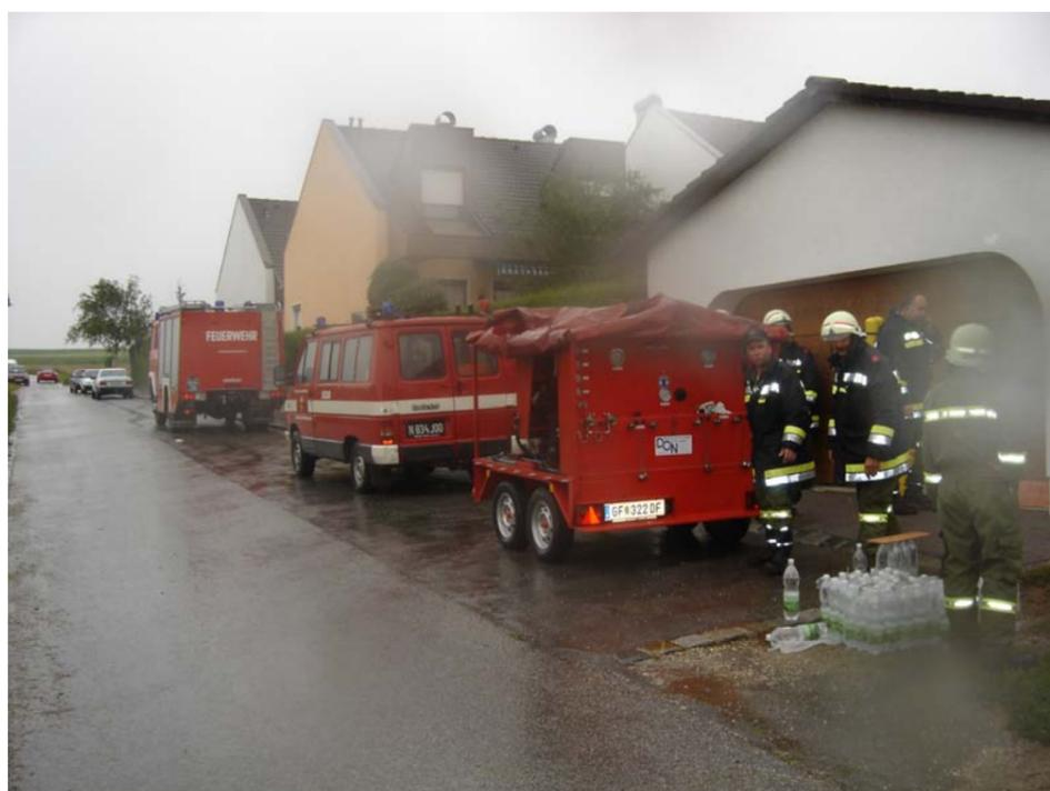
Zum ersten Mal hatten wir dabei unseren Atemluftkompressor im Einsatz, den wir im Frühjahr von der OMV über den Feuerwehrrabschnitt Gänserndorf erhalten haben. Dieses Gerät wurde von uns generalüberholt und stellt aufgrund seiner hohen Kompressorleistung eine weitere Bereicherung für den Brandeinsatz dar. Es ist das einzige Gerät im Bezirk mit dem sowohl die 200bar als auch die 300bar Atemluftflaschen gefüllt werden können.
